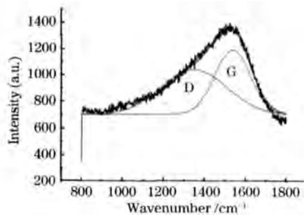
图1 沉积在机械瓣膜上的类金刚石膜的Raman光谱
