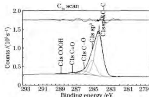
图3 XPS中的C<sub>1s</sub>电子能谱图
