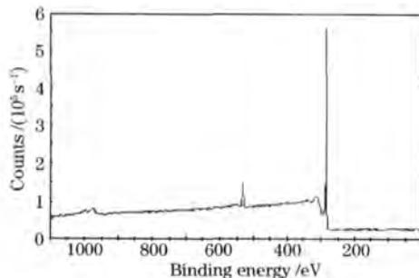
图2 沉积在机械瓣膜上的类金刚石薄膜的XPS全谱图
