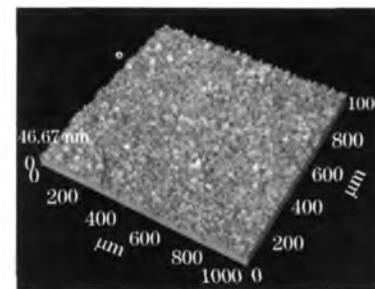
图4 类金刚石膜表面形貌的原子力显微镜图像
